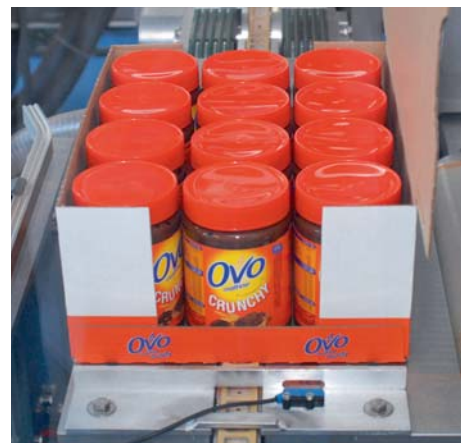
Blick in den noch offenen Karton mit einem 3×4-Packschema.
