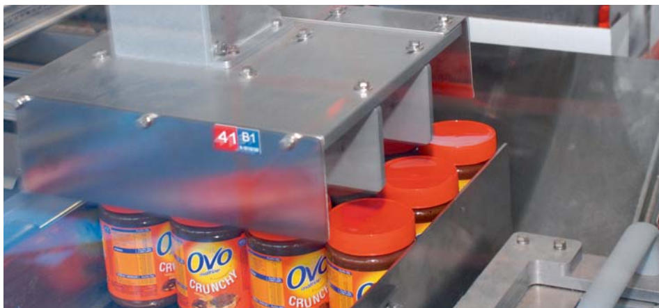
In der Gruppierstation werden die Gläser ausgerichtet.
