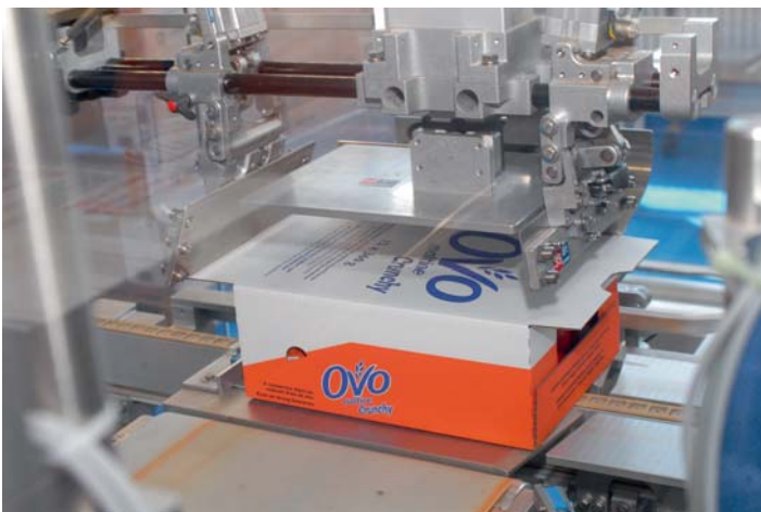
Auswechselbare Formatteile verschliessen den Karton.
