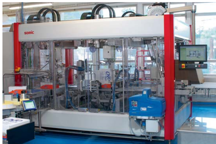
Gesamtansicht des Wrap-Around-Packers SOMIC 424 W3 bei Wander in der Produktion.
